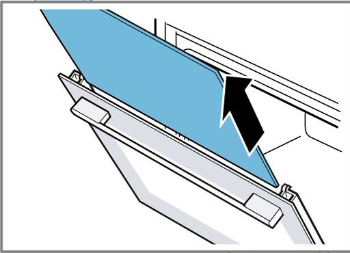
8. Si nécessaire, vous pouvez enlever la baguette de condensation pour le nettoyage.
