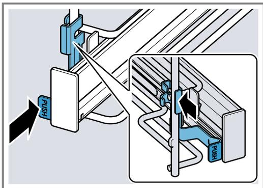
2. Maintenez enfoncé **PUSH** ① et faites pivoter le rail vers l'extérieur ②, jusqu'à ce que le support avant **a** soit accroché.
