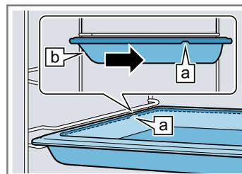
3. Pour poser les accessoires à des niveaux d'enfournement avec les rails télescopiques, sortir ces derniers.
