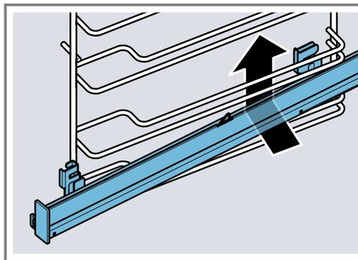
2. Guidez le rail dans le sens de la longueur vers les barres de guidage à l'arrière et poussez les deux supports à chaque fois sur la barre inférieure. Saisissez la barre verticale avec le support arrière **b**.
