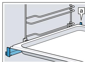
**Remarque :** Lorsqu'ils sont complètement sortis, les rails télescopiques s'enclenchent en place. Repousser les rails télescopiques dans le compartiment de cuisson en exerçant une légère pression.
