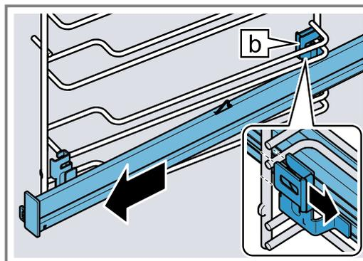
4. Die Auszugsschiene entfernen.
