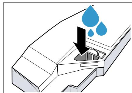
Maintenez toujours le réservoir d'eau de condensation rempli à l'horizontale pour qu'aucun liquide ne s'écoule.
