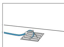
Poussez le tuyau d'évacuation d'eau complètement à travers le et fixez-le avec le matériel de fixation.
