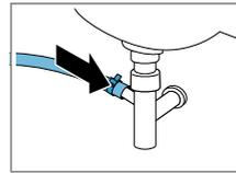
Die Anschlussstelle mit einer Schlauchschelle (24-40 mm) sichern.
