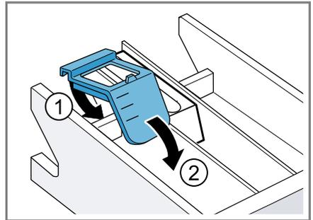
4. Die Waschmittelschublade einsetzen.
