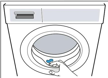
3. Die Gerätetür und die Waschmittelschublade offen lassen, damit Restwasser abtrocknen kann.
