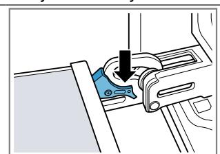
Дверца прибора зафиксирована и не может быть снята с петель.
