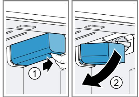
2. Den Wasserfilter nach links unten klappen ①, um 90° gegen den Uhrzeigersinn drehen ② und entnehmen ③.
