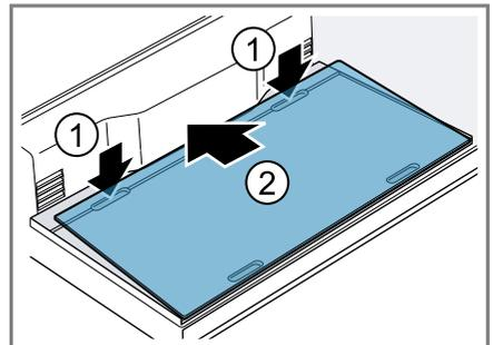
2. In die beiden Vertiefung vorn am Kühlfachboden greifen ①, die Kühl-
