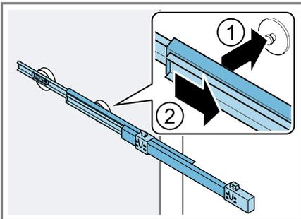
2. Die Auszugsschiene am hinteren Bolzen einsetzen ① und die Verriegelung nach hinten schieben ②.
