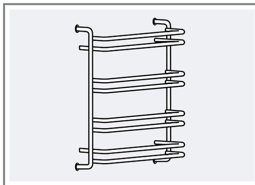
Bei richtig montierten Gestellen ist der Abstand zwischen den zwei oberen Einschubhöhen größer.
