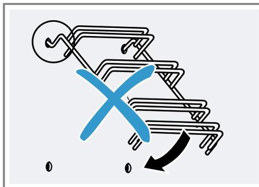
3. Beide Haken müssen vollständig in den oberen Löchern eingehängt sein. Das Gestell langsam und vorsichtig nach unten bewegen und in die unteren Löcher einhängen.
