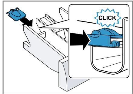
4. Die Waschmittelschublade einsetzen.
