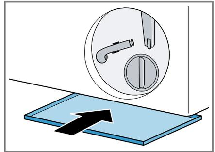
6. Den Entleerungsschlauch aus der Halterung nehmen.
