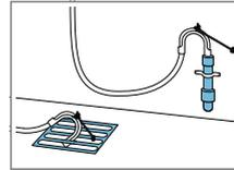
Den Wasserablaufschlauch mit einem Krümmer fixieren und sichern.
