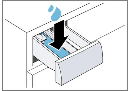
6. Pulvervollwaschmittel mit Sauerstoffbleiche in die Kammer II einfüllen.
