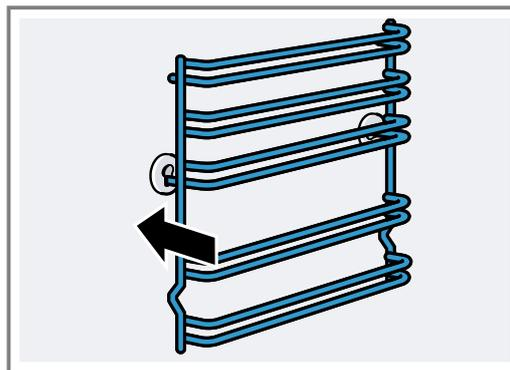
Die Gestelle passen rechts und links. Die Einschubhöhen 1 und 2 befinden sich unten, die Einschubhöhen 3, 4 und 5 oben.
