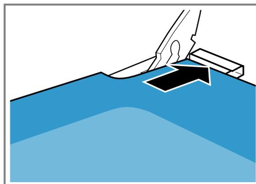
Deslizar el cristal en las dos aberturas de la parte inferior. La superficie lisa debe quedar hacia fuera, y la parte rugosa hacia dentro.
