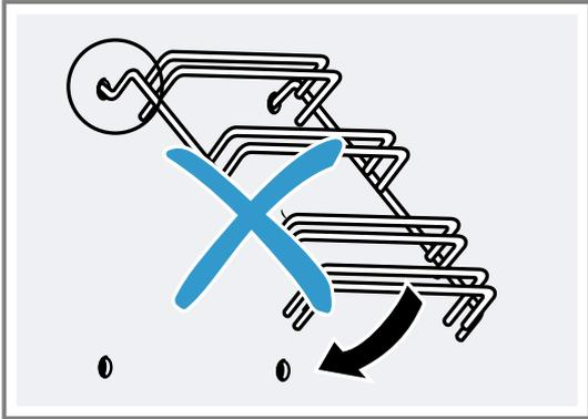
3. Los dos ganchos de sujeción deben estar totalmente encajados en los orificios superiores. Mover la rejilla despacio y con cuidado hacia abajo y engancharla en los orificios inferiores.
