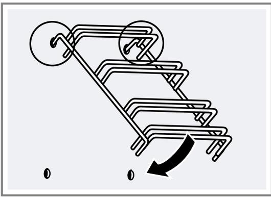
4. Enganchar las dos rejillas en las paredes laterales del horno.
