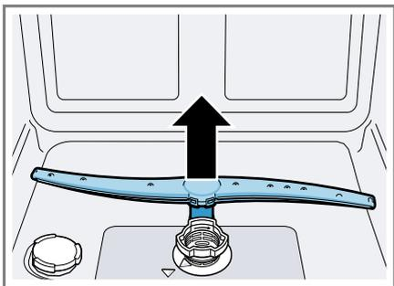
2. Verificar a existência de entupimentos nos orifícios de saída do braço aspersor sob água corrente e, se necessário, remover os corpos estranhos.
