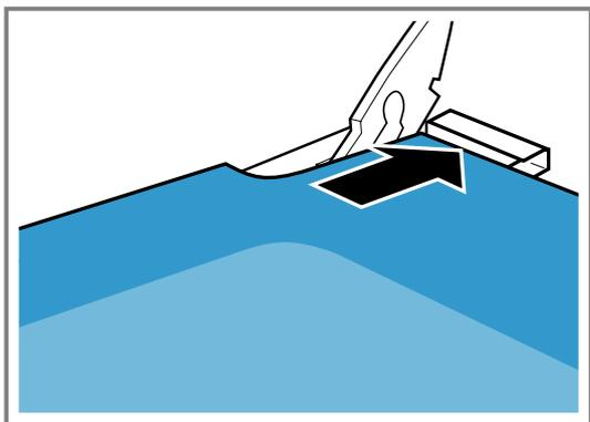
Die Scheibe in die beiden Öffnungen an der Unterseite einführen. Die glatte Fläche der Scheibe muss außen sein.
