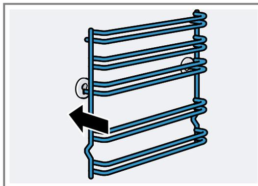
Die Gestelle passen rechts und links. Die Einschubhöhen 1 und 2 befinden sich unten, die Einschubhöhen 3, 4 und 5 oben.
