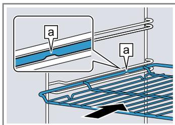
Blech Das Blech mit der Abschrägung
