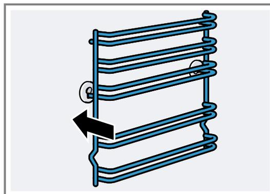
Les supports s'adaptent à droite et à gauche. Les niveaux d'enfournement 1 et 2 se trouvent en bas, les niveaux d'enfournement 3, 4 et 5 en haut.
