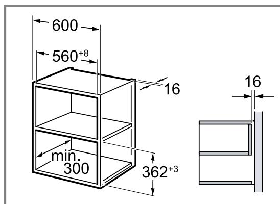
Encastrez l'appareil uniquement à une hauteur permettant de retirer sans problème les accessoires. Retirez les pieds.
