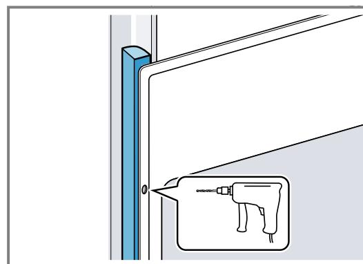
4. Das Gerät mit adäquater Schraube befestigen.
