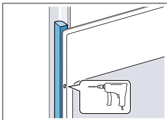
4. Fixez l'appareil avec une vis adéquate.
