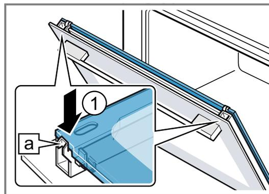
9. Colocar la cubierta de la puerta ① y presionar hasta que se oiga que ha encajado.
