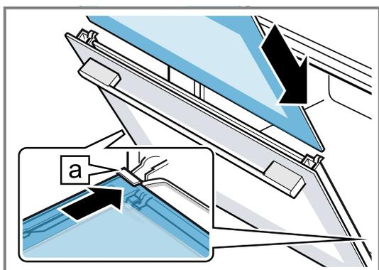
8. Presionar el cristal interior por arriba hasta que quede en las sujeciones izquierda y derecha [a].
