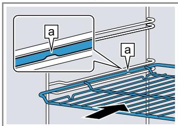
**Bandeja** p. ej., bandeja universal o bandeja de horno Introducir la bandeja con el bisel [a] hacia la puerta del aparato.
