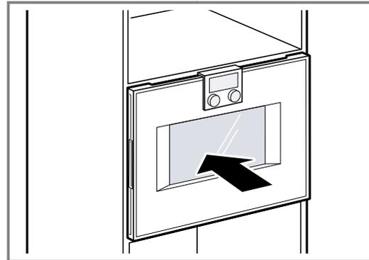
5. Das Gerät mittig ausrichten. Zwischen dem Gerät und den angrenzenden Möbelfronten ist ein Luftspalt von 5 mm erforderlich.
