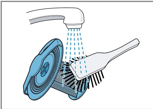
4. Das Ablaufsieb unter fließendem Wasser ausspülen oder bei starker Verschmutzung im Geschirrspüler reinigen.
