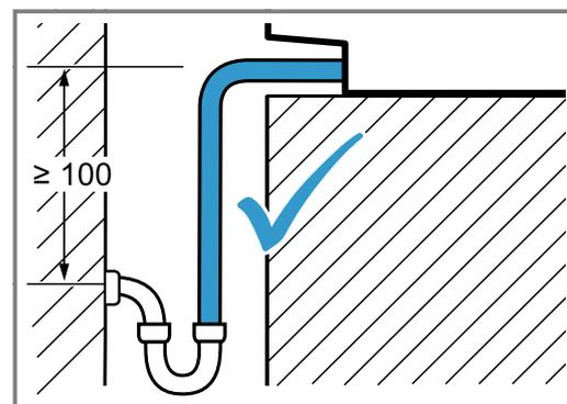
3. Den Ablaufschlauch an keiner Stelle tiefer als 500 mm als den Abwasseranschluss verlegen.
