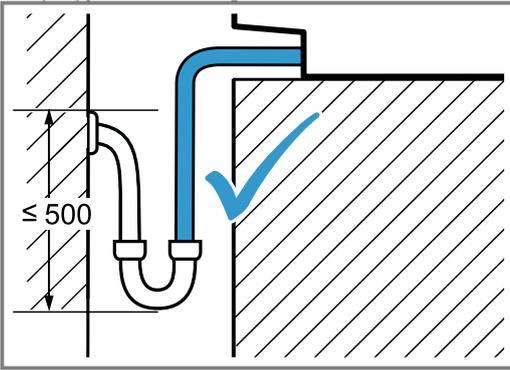
4. Der Abwasseranschluss darf nicht höher als das Gerät sein.
