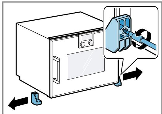
2. Die Transporthalterungen für den Zulaufschlauch und den Ablaufschlauch entfernen.
