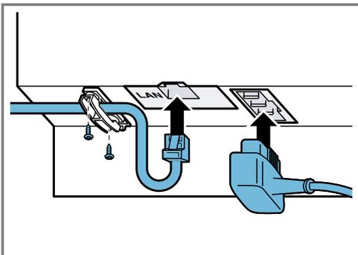
3. Das LAN-Kabel mit einem Netzwerkanschluss verbinden.
