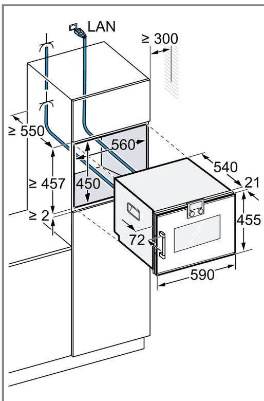
6. Wenn sich kein Zwischenboden über dem Gerät befindet, das Gerät im Schrank gegen Kippen sichern. 2 handelsübliche Winkel beidseitig im Schrank auf 450 mm Tiefe, 5 mm über der Gerätehöhe befestigen.
