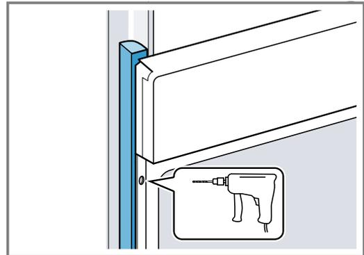
3. Gerät mit adäquater Schraube befestigen.
