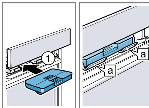
9. Die Bedienblende langsam nach unten schieben, dann nach hinten drücken, bis die Bedienblende vollständig geschlossen ist.
