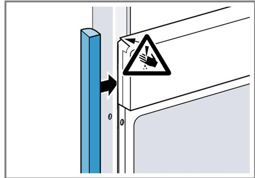
2. Aluprofile vorbohren, um eine Schraubverbindung herzustellen.
