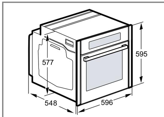
**27.3 Einbau unter einer Arbeitsplatte**
