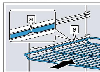
Blech Das Blech mit der Abschrägung
