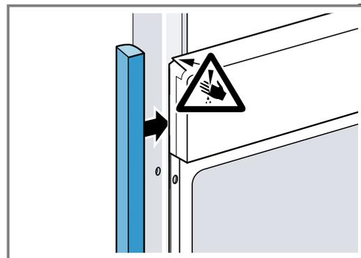
2. Aluprofile vorbohren, um eine Schraubverbindung herzustellen.
