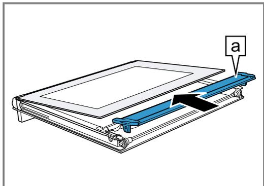
8. Die Innenscheibe mit der Halterung
