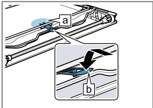
6. Die Innenscheibe so auf die Gerätetür legen, dass die Nummer **a** rechts unten lesbar ist. Die Innenscheibe schräg nach hinten in die Befestigungsschiene **b** einsetzen.
