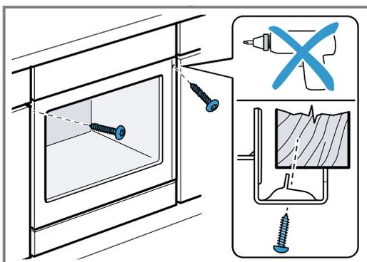
8. Die Gerätetür etwas öffnen, die Blenden anlegen und zuerst oben, dann unten festschrauben.
