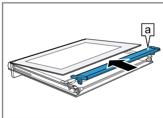
8. Die Innenscheibe mit der Halterung **a** in die Öffnung einsetzen.
