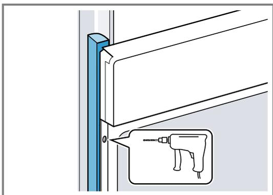
4. Das Gerät mit adäquater Schraube befestigen.
