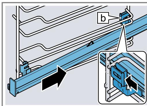
3. **PUSH** gedrückt halten ① und die Auszugsschiene nach innen schwenken ②, bis die Halterung [a] in den unteren Stab einhängt ist.
