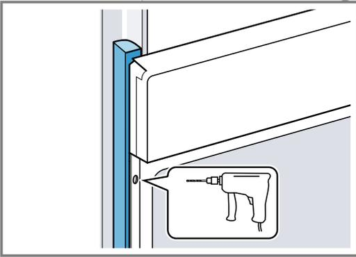
3. Gerät mit adäquater Schraube befestigen.
