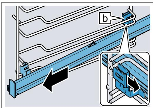
4. Die Auszugsschiene entfernen.
