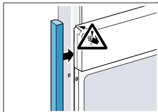
2. Aluprofile vorbohren, um eine Schraubverbindung herzustellen.
