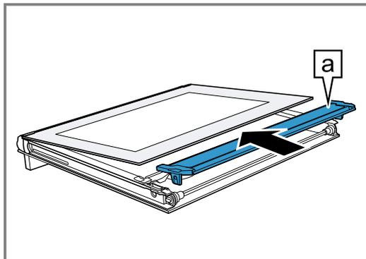
8. Die Innenscheibe mit der Halterung
