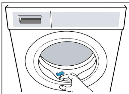
3. Laissez la porte de l'appareil et le bac à produits ouverts afin que l'eau résiduelle puisse s'évaporer.
