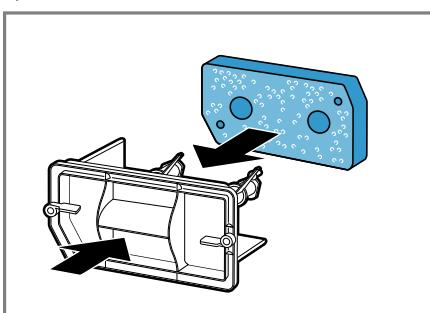
Слідкуйте за тим, щоб після очищення фільтруюча прокладка не була пошкоджена, деформована або встановлена в кріплення неправильно.
