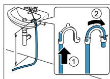
Повністю проштовхніть водовідвідний шланг через закруглене кріплення і закріпіть його кріпильним матеріалом.
