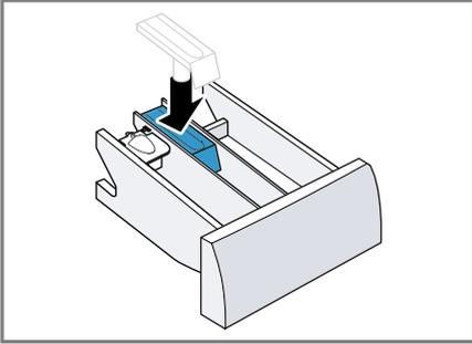
6. Die Öffnung für die Waschmittelschublade reinigen.
