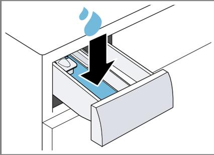
5. Pulvervollwaschmittel mit Sauerstoffbleiche in die Kammer II einfüllen.
