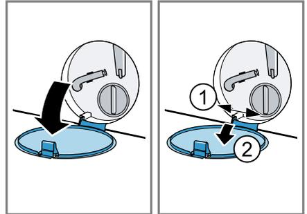
5. Ein passendes Gefäß zum Ablassen der Waschlauge unter die Öffnung schieben.
