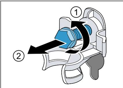
3. Die Netzanschlussleitung von der Halterung entfernen.
