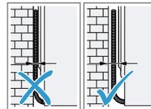
Keine Netzanschlussleitung und keine Schläuche zwischen Wand und Gerät einklemmen.
