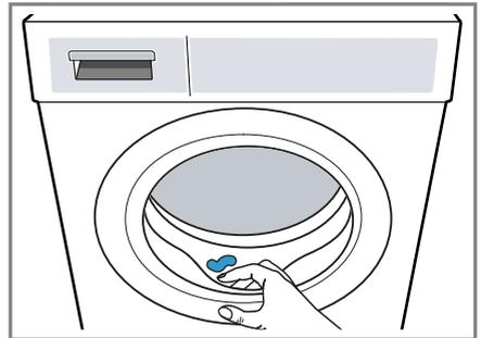
3. Die Gummimanschette außen und innen mit einem feuchten Tuch reinigen und trocken wischen.
