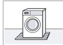
Das Gerät auf einer wasserbeständigen Holzplatte (Stärke mind. 30 mm) aufstellen, die fest mit dem Fußboden verschraubt ist.
