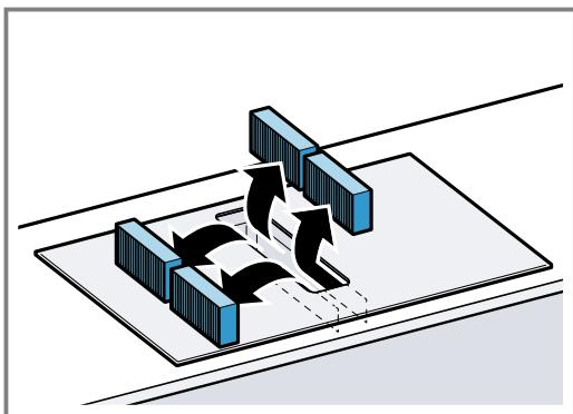
4. 2 filtera za neprijatne mirise ili filtere zvuka postavite u uređaj sa leve i desne strane i gurnite ih unapred.
