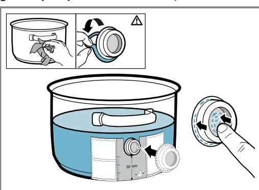
3. Pritisnite cijelu površinu i unutarnji dio silikonske pločice.
