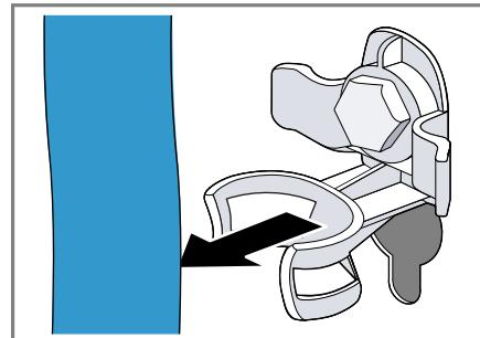
2. Alle Schrauben der 4 Transportsicherungen mit einem Schraubenschlüssel SW13 lösen ① und entfernen ②.
