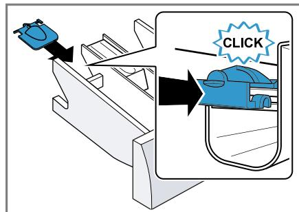
4. Die Waschmittelschublade einsetzen.
