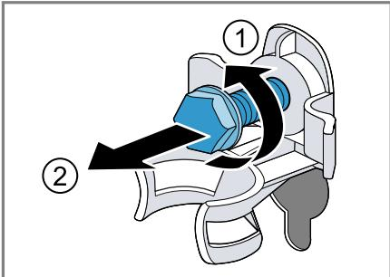
3. Die Netzanschlussleitung von der Halterung entfernen.
