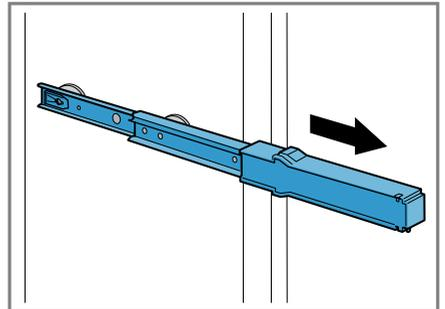
2. Die Verriegelung in Pfeilrichtung schieben ① und vom hinteren Bolzen lösen ②.
