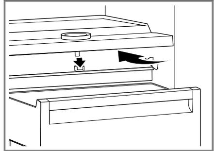
3. Die Glasplatte auf die Trennplatte setzen.
