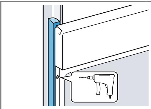
3. Gerät mit adäquater Schraube befestigen.
