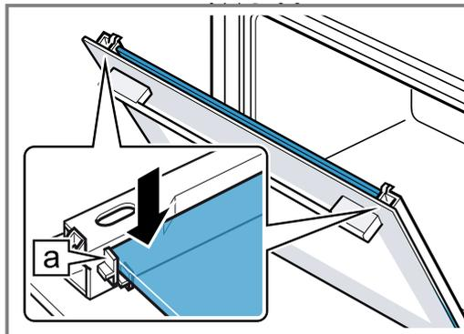
5. Die Gerätetür öffnen und Türdichtung einhängen.
