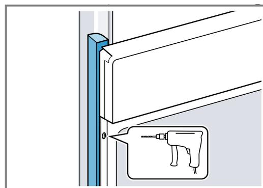
3. Gerät mit adäquater Schraube befestigen.
