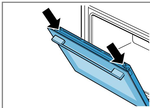
4. Die Gerätetür ganz öffnen und in Richtung Gerät drücken.
