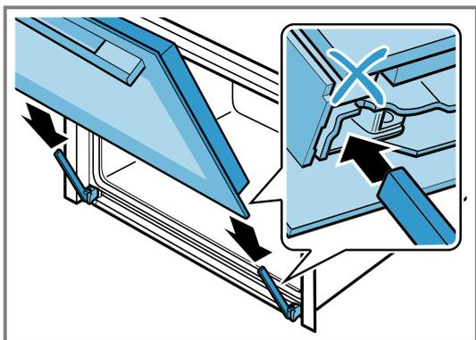
3. Mit beiden Händen von oben links und rechts auf die Türabdeckung drücken, um zu prüfen, ob die Gerätetür bis zum Anschlag eingeschoben ist.
