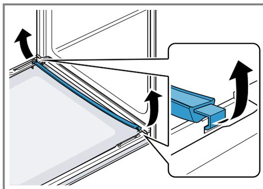
9. Bei Bedarf können Sie die Kondensatleiste zum Reinigen herausnehmen.
