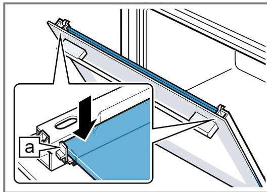
5. Die Gerätetür öffnen und Türdichtung einhängen.
