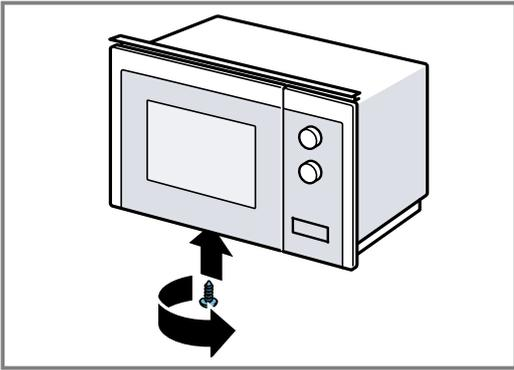
4. Soltar los dos tornillos exteriores de la base del microondas.
