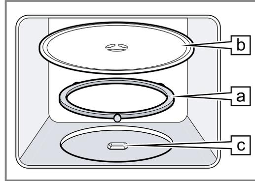
2. Encaixe o prato rotativo [b] no acionamento [c], no centro do fundo do interior do aparelho.
