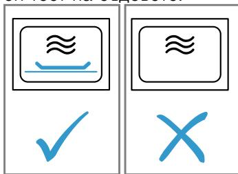
При приготвянето на пуканки в микровълнова с висока мощност стъклото на вратата може при претоварване да се пукне.
