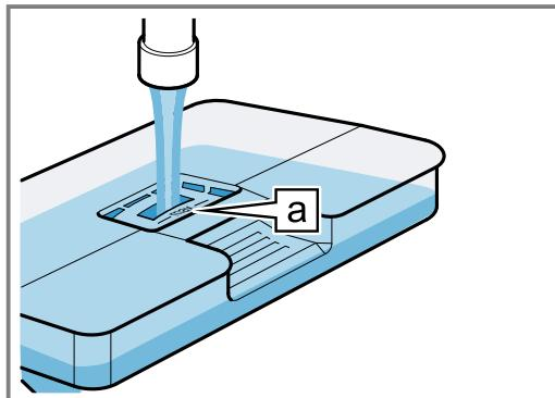
6. Vstavite napolnjen rezervoar za vodo ①. Pri tem pazite, da se rezervoar za vodo zaskoči v držala [a].
