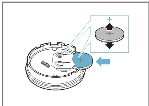
**Nota:** No usar objetos metálicos para quitar la batería. No tocar la zona de bornes de contacto de la batería.
