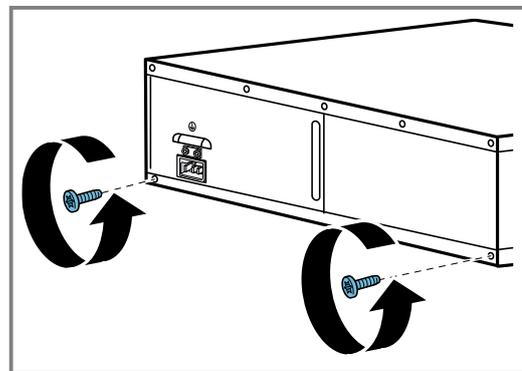
5. Serrare i due supporti metallici nella parte posteriore dell'apparecchio utilizzando le due viti.
