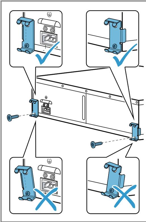
6. Spingere l'apparecchio nel mobile da incasso e verificare che la protezione antiribaltamento si innesti.
