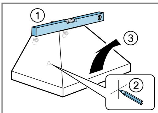
4. Percez le trou pour la vis de blocage  $\varnothing 8$  mm et la profondeur de perçage de 80 mm et enfoncez la cheville à fleur du mur. ①
