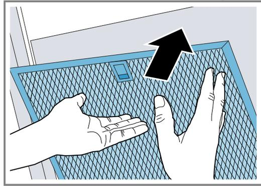
3. Falls der Fettfilter falsch eingesetzt wurde, die Verriegelung vorsichtig nach vorne drücken, den Fettfilter entnehmen und korrekt einsetzen.
