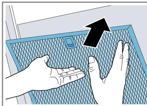
3. Si le filtre à graisse a été mal inséré, poussez avec précaution le loquet vers l'avant, retirez le filtre à graisse et insérez-le correctement.
