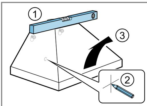
4. Boor het gat voor de borgschroef  $\varnothing$  8 mm en boordiepte 80 mm en duw de pluggen er vlak met de wand in. ①
