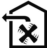
El aire no se puede desviar a una chimenea que se use para los gases residuales del aparato que queman gas u otros combustibles (esto no se aplica a los aparatos de recirculación de aire).
