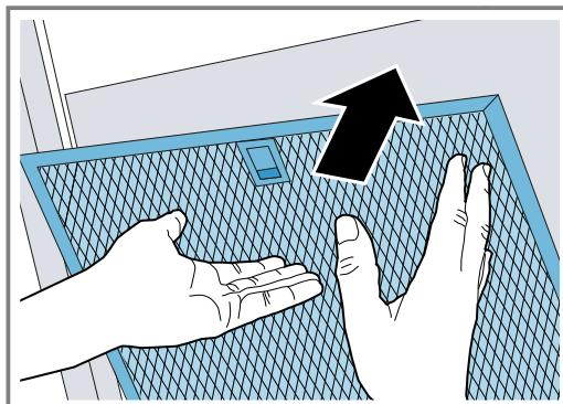
3. Se o filtro de gorduras tiver sido colocado incorretamente, pressione o bloqueio com cuidado para a frente, retire o filtro de gorduras e coloque-o corretamente.
