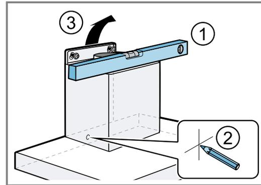
4. Das Loch für die Sicherungsschraube  $\varnothing$  8 mm und Bohrtiefe 80 mm bohren und den Dübel wandbündig eindrücken. ①
