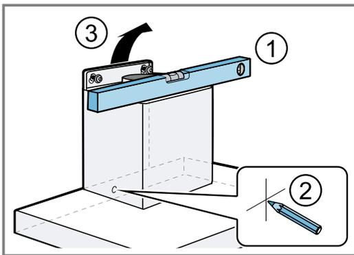
4. Praticare il foro per la vite di sicurezza con  $\varnothing$  8 mm e una profondità di 80 mm e inserire il tassello a filo del muro. ①
