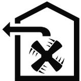
L'aria non deve essere deviata in un camino che viene utilizzato per lo scarico di gas di apparecchi che bruciano gas o altri combustibili (questo non vale per apparecchi a ricircolo d'aria).
