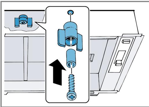
Die Schraube, die Flügelmutter und die Hülse liegen dem Geruchsfilter bei.
