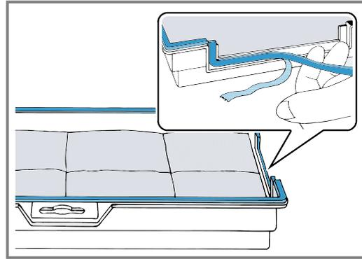
5. Den Geruchsfilter hinten einsetzen ① und hochklap-pen ②.
