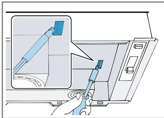
4. Den Geruchsfilter mit dem beiliegenden Dichtstreifen abkleben.
