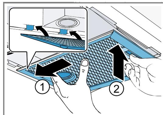
2. Die Fettfilter nach oben klappen und die Verriegelungen einrasten.
