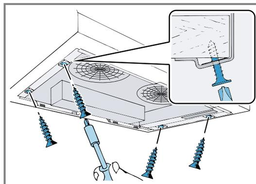
4. Sicherstellen, dass das Gerät an der unteren Kante flächenbündig zum Umbau abschließt.
