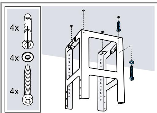
4. Vier Löcher mit Ø 8 mm und Bohrtiefe 80 mm für die Befestigungen bohren und die Dübel bündig eindrücken.
