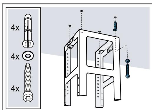
4. Faça quatro furos com 8 mm de Ø e 80 mm de profundidade para as fixações e introduza as buchas à face.
