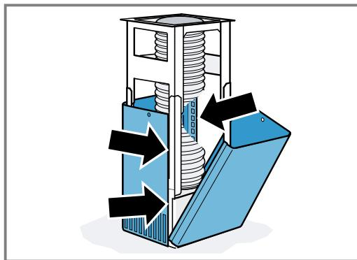
**Nota:** Las ranuras del revestimiento de la chimenea deben colocarse hacia abajo.
