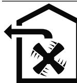
El aire no se puede desviar a una chimenea que se use para los gases residuales del aparato que queman gas u otros combustibles (esto no se aplica a los aparatos de recirculación de aire).
