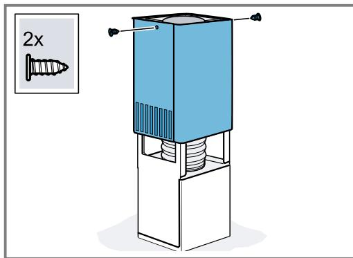
5. Colocar ambas partes del revestimiento inferior de la chimenea sobre el aparato y acoplarlas.
